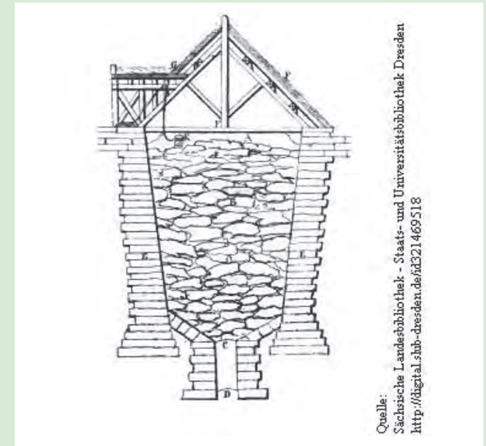
Querschnitt einer Eisgrube (um 1825) (aus: www.eiskeller-brandenburg.de , Abb. 1-04)
